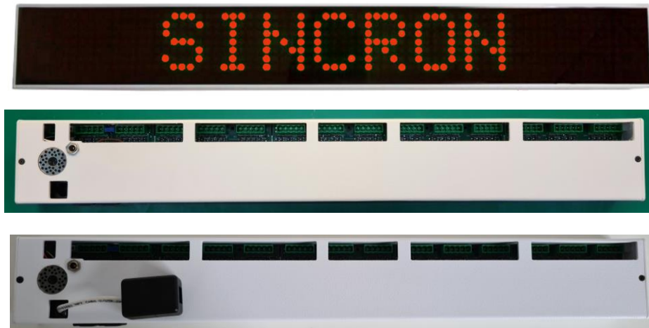
Figura 7 - Painel de Mensagem Repetidor
