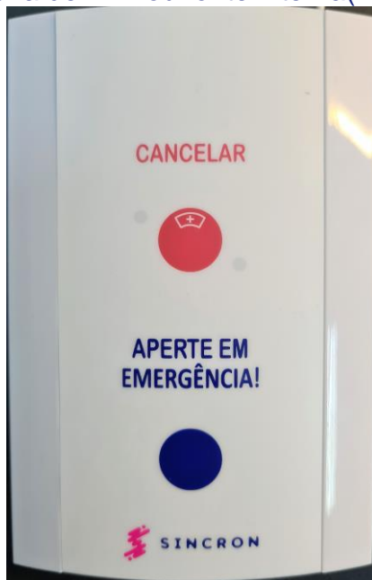
Figura 4 - Estação de Leito/Banheiro
